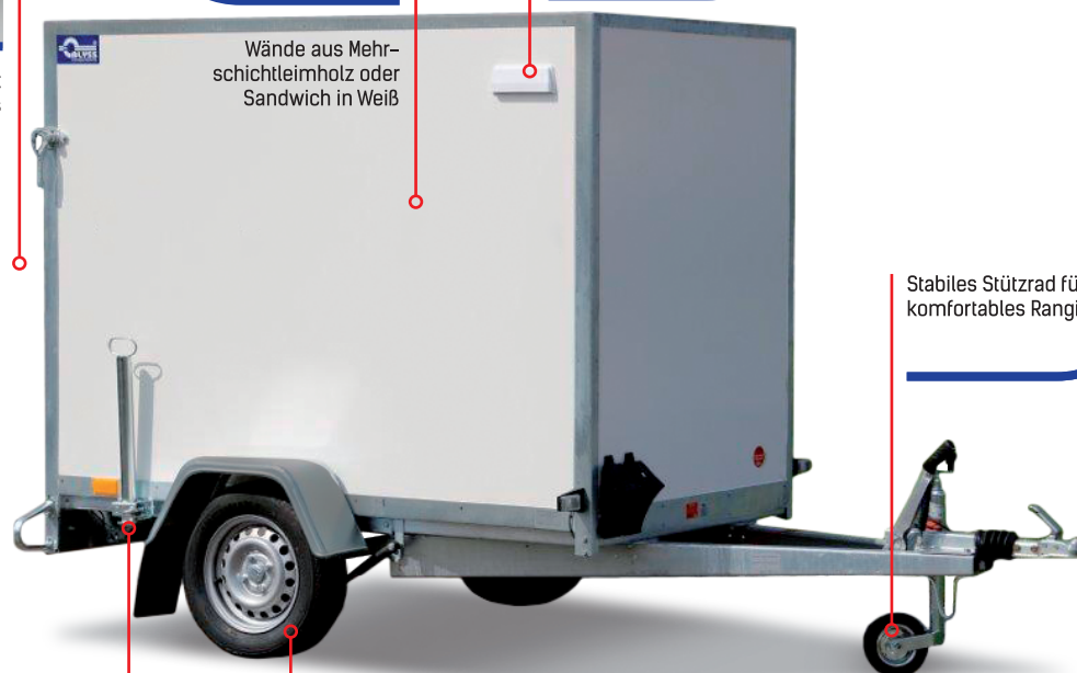
Stoßdämpfer erhöhen die Spursicherheit und den Fahrkomfort des Anhängers
