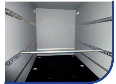
Serienmäßige Verzurrschienen (Sperrstange optional)
