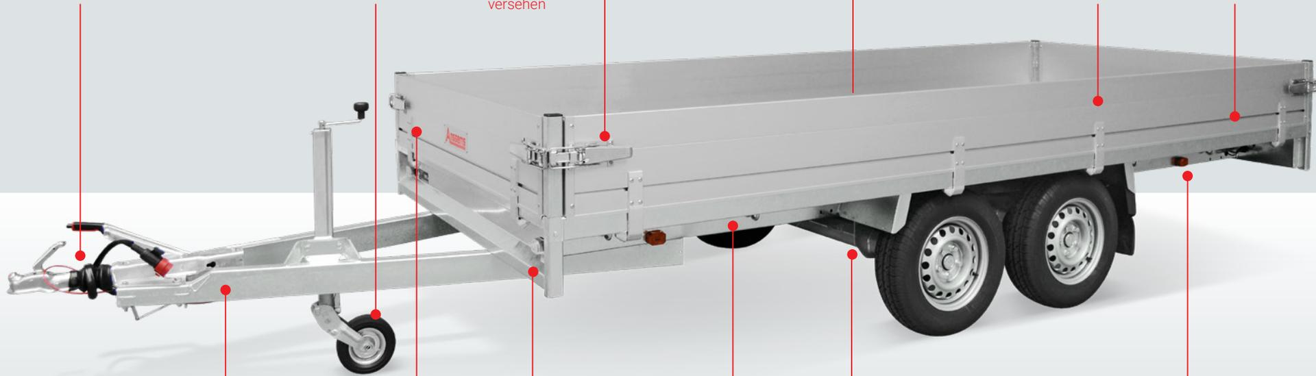
Lange Deichsel aus Rechteckrohrprofil
