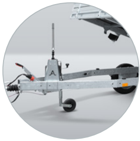
Deichselprofile führen bis zur Rückseite der Ladeplattform
