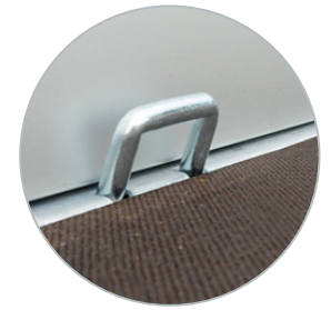
8 Bindehaken an der Innenseite der Ladeplattform
