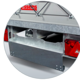
Serienmäßig mit integrierten Halterungen für Auffahrrampen ausgestattet
