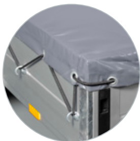
Zubehör: Flachplane, schnell zu montieren
