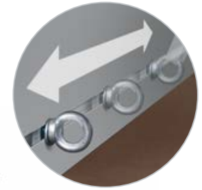
Integrierte Schiene im Laderaum zur optimalen Ladungssicherung
