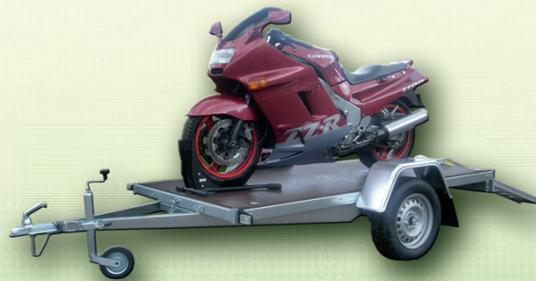
Anhänger ohne Bordwände können als Plattformanhänger genutzt werden, z. B. für Transporte von Ladungen mit außergewöhnlichen Abmessungen oder Motorrädern.
