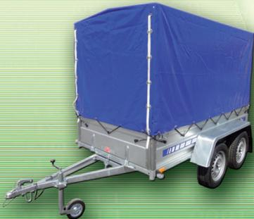
Plane mit Spiegel vergrößert erheblich die Anwendungsmöglichkeit des Anhängers. Tandem - Anhänger der Stabilste, auch für Führerscheinklasse BE geeignet!
