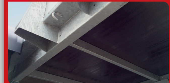
Stabiles Fahrestell mit sehr massiver Konstruktion Very robust welded chassis with tubular cross parts
