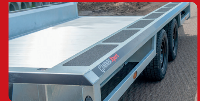
Xpert-Version Schwarzes Reflexionsband an Front und Seiten, schwarze Felgen, Seitenmarkierungsleuchten, LED-Rückleuchten mit Rückleuchtenschutz, rote Reflexion auf der Heckklappe
