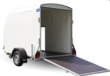
Der Kofferanhänger Niki ist ein Fortschritt für diejenigen, die das Aussehen und die Funktionalität schätzen. Die aerodynamische Form und der effektive äußere Charakter des Anhängers ermöglichen einen überraschend großen Laderaum. Die serienmäßige Überfahrband hinten, mit Gasfederunterstützung, ermöglicht bequemes und einfaches Auf- und Abladen von Motorrädern.
