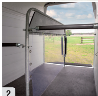
2 Herausnehmbare Mitteltrennwand Steal partition
