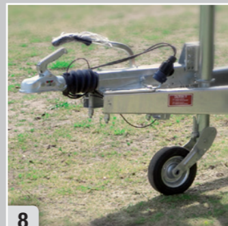
8 Automatikstützrad Heavy jockey wheel
