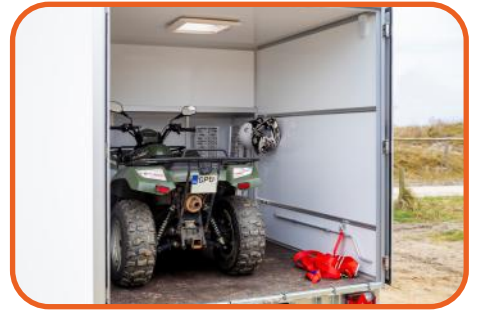
Laderaum mit Dachluke
