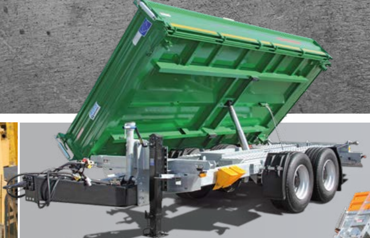
Exclusive Gala Exclusive 140.51/242 Breitreifung 385/55 R19.5 mit Kastenaufsatz 500 mm
